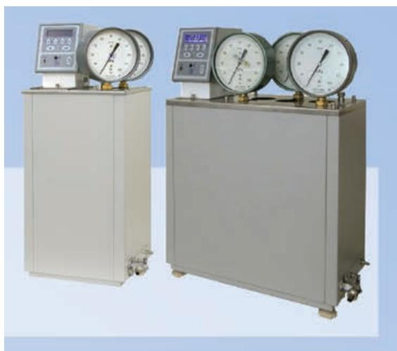
Сущность метода определения ДНП по Рейду заключается в измерении давления насыщенных паров испытуемого продукта в бомбе, состоящей из топливной и воздушной камер, при температуре  $(37,8 \pm 0,1 \text{ } ^\circ\text{C})$
